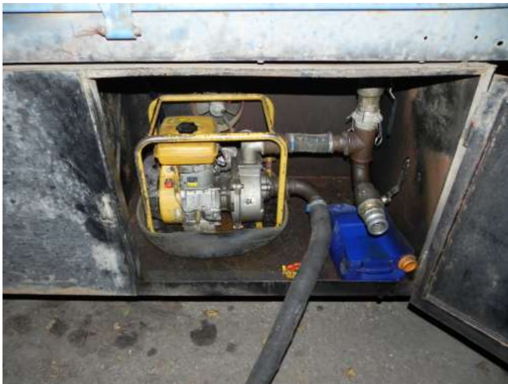
Рис. 9. Вид бензиновой помпы, установленной в грузовом автомобиле, предназначенной для перекачивания похищенных нефти и нефтепродуктов из накопительной емкости в емкость, находящуюся в его кузове.
