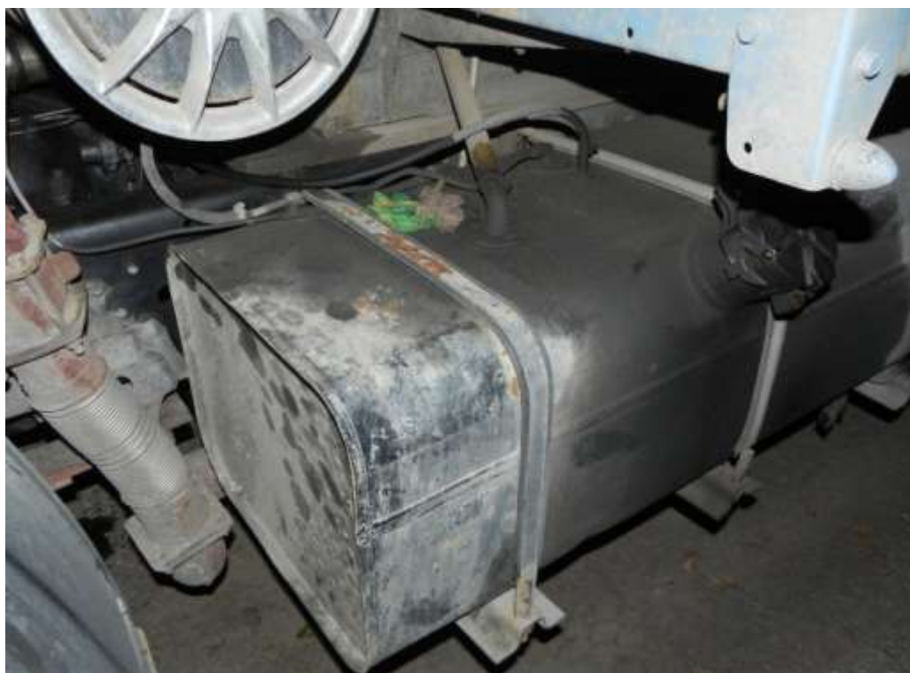
Рис. 10. Вид бензобака, соединенного с емкостью для перевозки похищенных нефтепродуктов, для его пополнения в случае необходимости.
