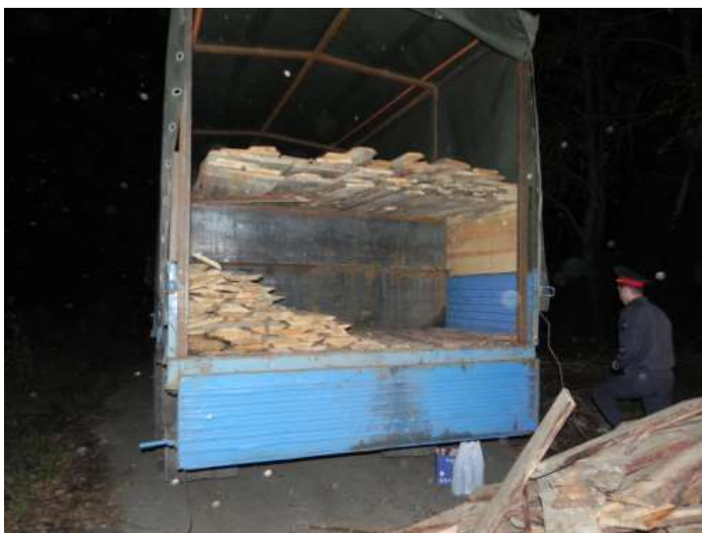
Рис. 14. Вид кузова автомобиля с замаскированной емкостью для перевозки похищенных нефти и нефтепродуктов.
