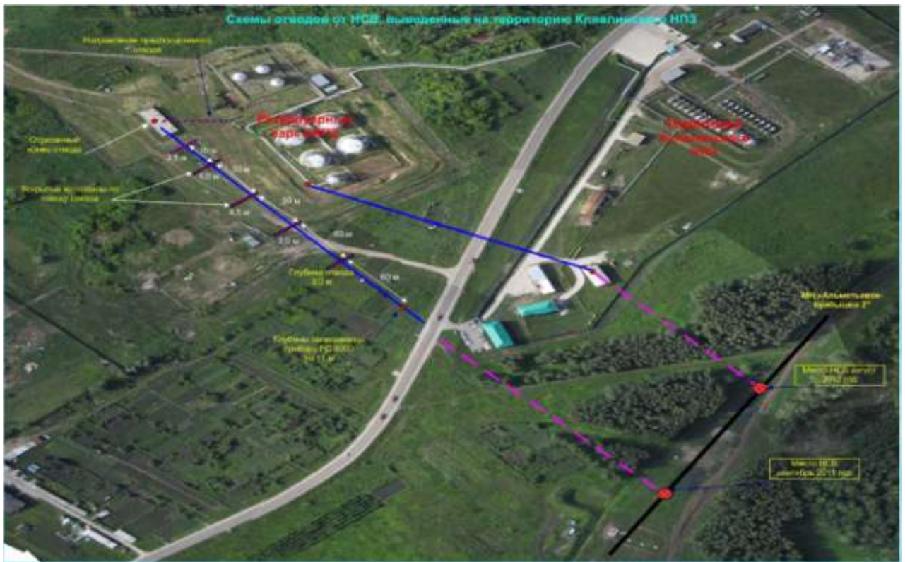
Рис. 19. Вид участка местности, где пролегает магистральный нефтепровод «Альметьевск – Куйбышев 2», в теле которого были обнаружены врезки с отводами на территорию Клявлинского НПЗ Самарской области, расположенного в относительной близости.
