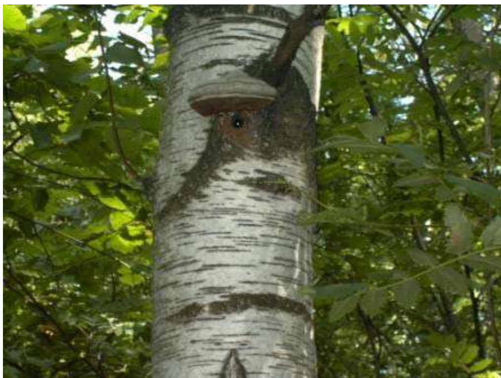
Рис. 17. Вид замаскированной видеокамеры, установленной в стволе дерева для наблюдения за врезкой в трубопровод.
